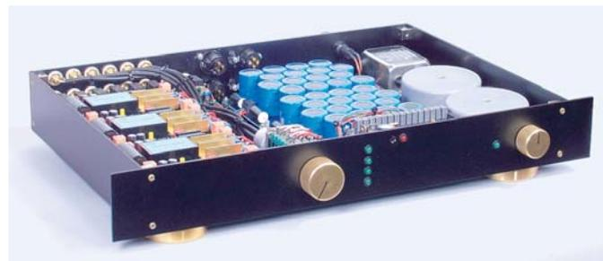
**108** Speziell für High-End-Audioanwendungen entwickelte Thomas Hartwig seinen Audio-Operationsverstärker Music Amp 2000. HOBBY HiFi präsentiert eine Sechskanal-Vorstufe für 5.1-Surround auf der Basis dieses Schaltkreises, die ausschließlich im Selbstbau entsteht.
