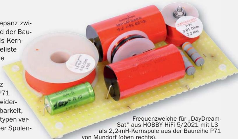
Frequenzweiche für „DayDream-Sat“ aus HOBBY HiFi 5/2021 mit L3 als 2,2-mH-Kernspule aus der Baureihe P71 von Mundorf (oben rechts).
